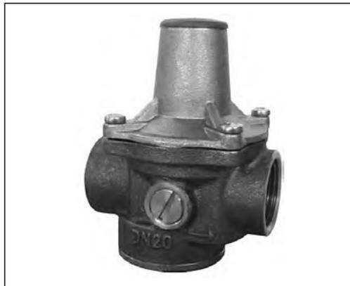
Клапан редукционный тип 7BIS является регулятором давления прямого действия «после себя» и предназначен для снижения и поддержания постоянного давления за клапаном вне зависимости от колебаний давления до него.
